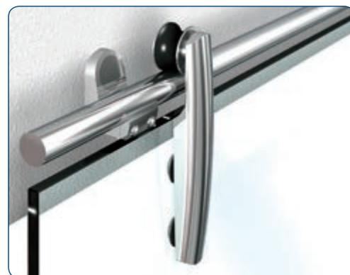
Abstand und Anzahl der Laufschiene Klemme ist abhängig von der Türblattbreite. Mindestens zwei Klemmen sind stets oberhalb des Türblattes einzuplanen, um so eine Aushebesicherung zu gewährleisten.
