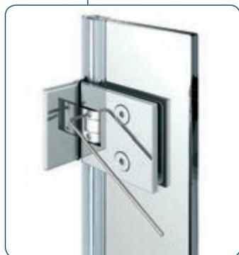
Die Nulllage ist beliebig oft und stufenlos verstellbar. Durch diese Nulllageneinstellung können die Beschläge schneller montiert werden – auch bei Wänden, deren Fluchten nicht zueinander stehen.
